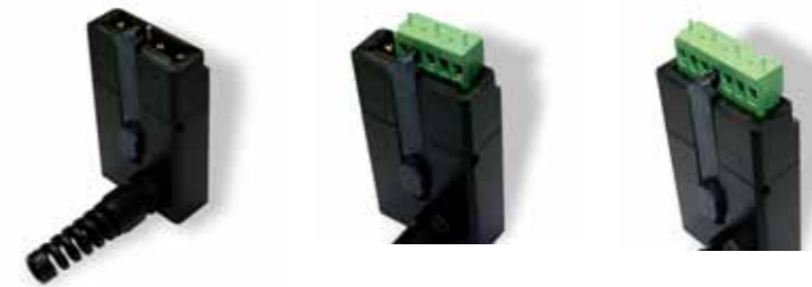
Repülőgépeknél alkalmazott csatlakozók tesztelésére kifejlesztett JIG-ek
