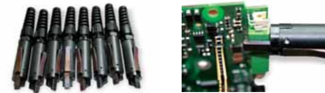
Nyomatott áramkörökön lévő csatlakozók tesztelése JIG-ekkel
